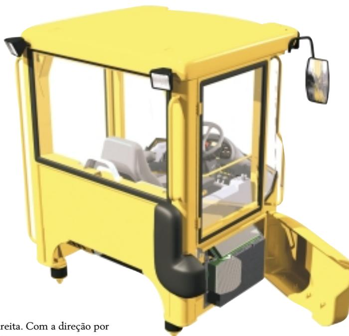
hidráulico à direita. Com a direção por alavanca (CDC)\* o operador manobra a direção, as funções de marcha à frente, marcha à ré e kick-down a partir do controle no apoio do braço esquerdo. O operador pode, a qualquer momento, mudar do volante para a direção por alavanca e assim evitar a monotonia e reduzir o cansaço. Isto proporciona ao operador a possibilidade de variar a maneira de dirigir e assim reduzir o esforço muscular.
