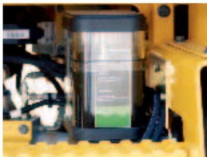
**Système de graissage centralisé automatique\***
