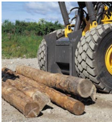
Med timmerfösare och utskjut kan du bygga högre vältor och utnyttja upplagets lageryta effektivare.
