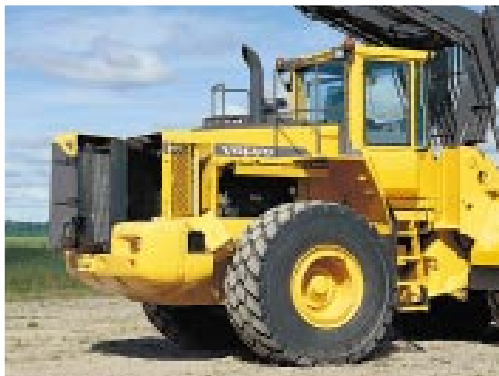
Öppningsbara gasfjädrade motorluckor samt utfällbar kylarkåpa och kylare förenklar service och rengöring.
