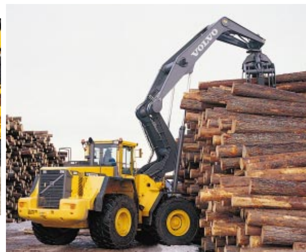
Med timmerfösare och utskjut kan du bygga högre vältor och utnyttja upplagets lageryta effektivare.
