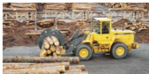
Den långa hjulbasen och kompakta lyft-armsgeometrin ger nödvändig stabilitet för timmerhantering med helstamsgaffel.
