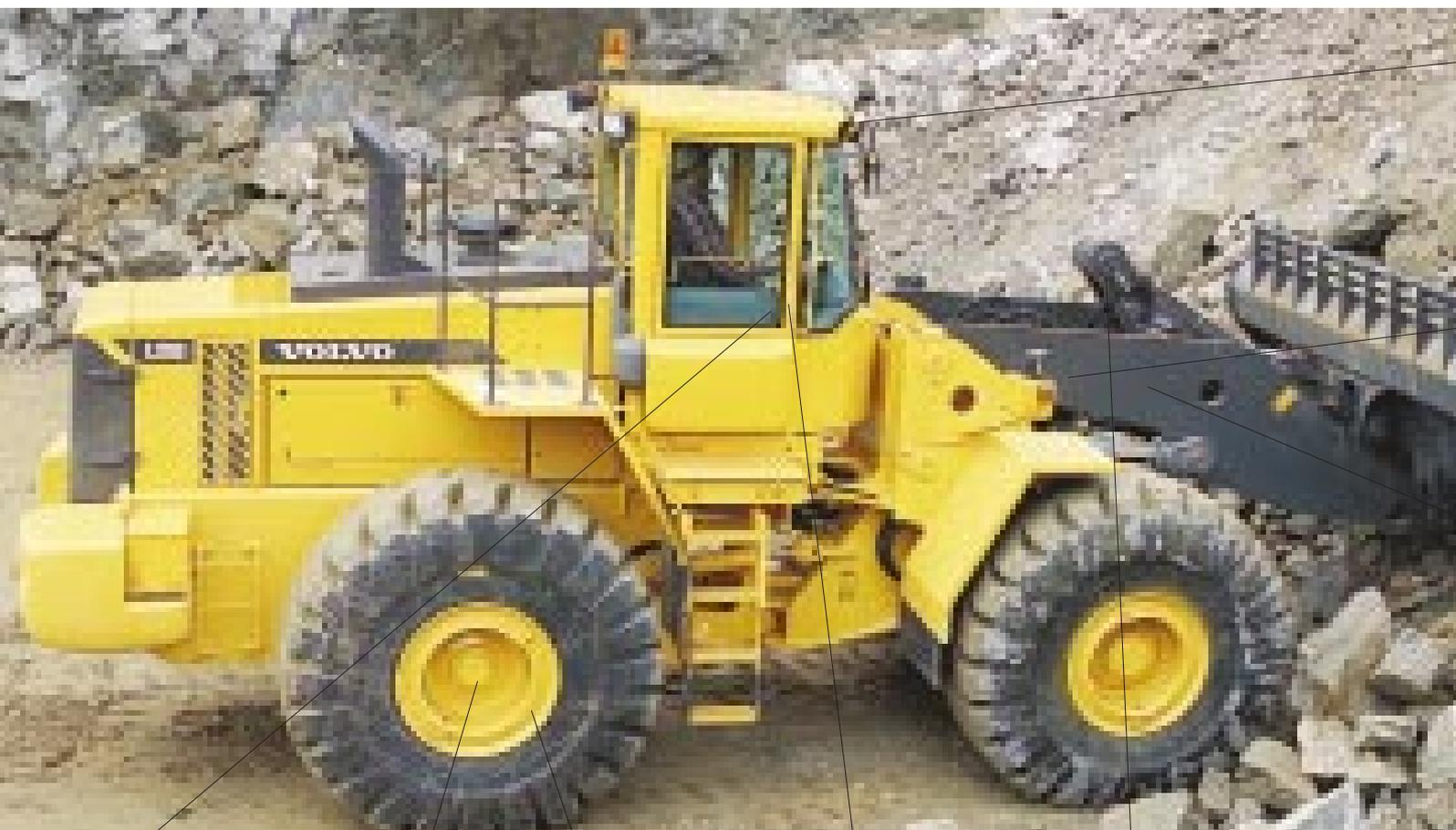
*Le système de changement de vitesses automatique APS II permet au conducteur de pré-régler les points de changement de vitesses en fonction du degré de difficulté du travail et, ainsi, de réaliser des économies de carburant.*
