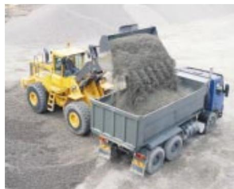
suspension des bras de levage (en option), Boom Suspension System, le conducteur peut maintenir une cadence de travail plus élevée lors des opérations de chargement transport, y compris en présence de sols irréguliers.
