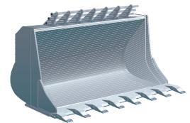
Godets droits pour front de taille, munis de dents. Pour pierres et autres matériaux demandant une grande capacité de pénétration et d'excavation. Les godets sont munis de parois latérales basses pour optimiser la capacité de pénétration.
