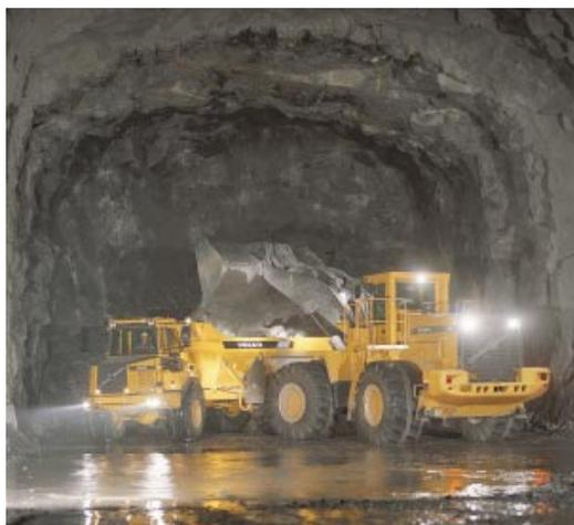
La chargeuse Volvo L330D est équipée d'une articulation en Z, de ponts largement calculés et de châssis qui font d'elle une machine idéale pour les travaux lourds au front de taille. Différentiels à glissement limité, hydraulique à détection de charge, moteur hautes performances à faible taux d'émission et couple moteur élevé à bas régimes, contribuent à la doter de la consommation de carburant la plus faible de sa catégorie.
