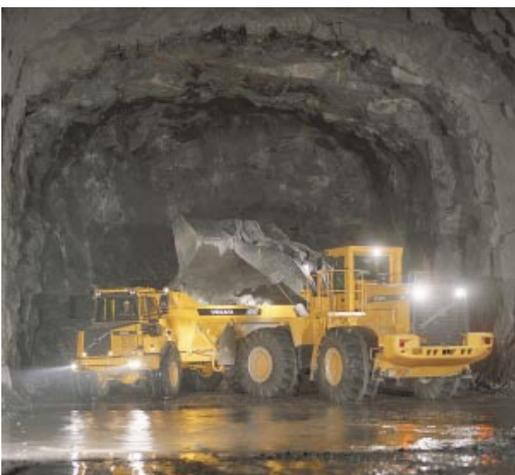
Der Volvo L330D hat ein Z-Hubgerüst, robust dimensionierte Achsen und einen ausgesprochen kräftigen Rahmen; er eignet sich daher gut für den harten Einsatz in Steinbrüchen. Sperrdifferentiale, Load-Sensing-Hydraulik und Hochleistungs-Niederemissionsmotor mit hohem Drehmoment im niedrigen Drehzahlbereich machen ihn zu einem der wirtschaftlichsten Radlader seiner Klasse.
