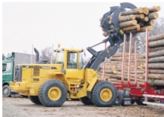
La cinemática TP muestra su potencial, tanto en trabajos de arranque como de manipulación. Ningún otro sistema puede proporcionar tan alto par de arranque a lo largo del ciclo de elevación.
