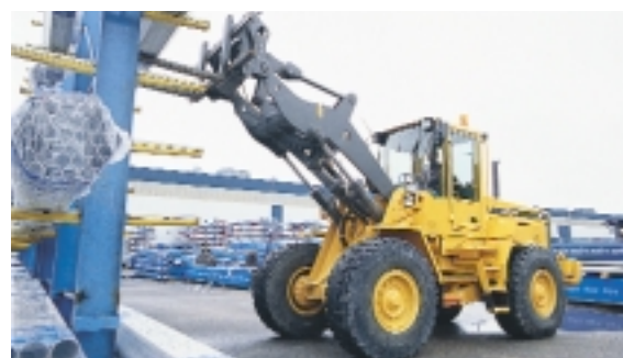
El portaimplementos de visibilidad optimizada y la cinemática TP refinada proporcionan una buena visión del implemento y la carga.
