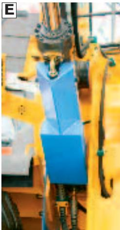
**E** **Schlauch- und Rohrschutz, Hubzylinder**
