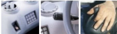
**Izquierda:** Diez salidas de aire proporcionan aire puro filtrado y un clima controlado. El panel de control Contronic II brinda acceso directo a todas las funciones principales de supervisión. **Centro/derecha:** Adelante, atrás o kick-down – El cambio APS II puede controlarse con palanca de cambios, interruptor basculante en la consola hidráulica o con el CDC\*\*\*.
