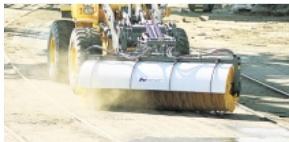
Gracias a la transmisión hidrostática, con su función de avance ultralento\*\*, la L50D puede maximizar la potencia a los implementos mientras se desplaza a baja velocidad.
