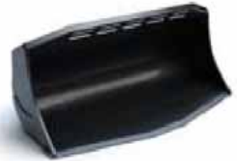
L350F Godet trapézoïdal pour roche, pour montage sur porte-outil
