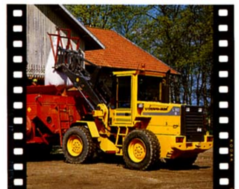
Det stora antalet redskap gör Volvo BM L50B till en av de mångsidigaste maskinerna i sin klass. Här är L50B försedd med ett specialredskap för hantering av storsäck.
