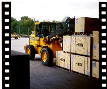
Lång räckvidd och god balans tack vare den långa hjulbasen gör att du kan precisionslasta "på distans". Det höga brytmomentet underlättar hantering av tungt gods.
