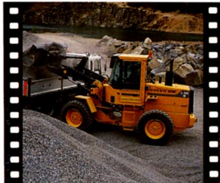
Det nya lastaggregatet TP-linkage gör Volvo BM L50B till en smidig och effektiv skopplastare. TP-linkage ger högt brytmoment inom hela lyftområdet.
