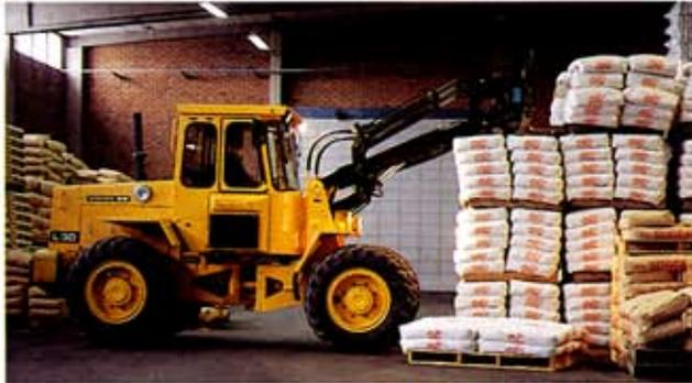
Un buen control de la carga, incluso en superficies pequeñas y estrechas. Desplazamiento en paralelo, articulación central y ángulo de dirección de 40°.
