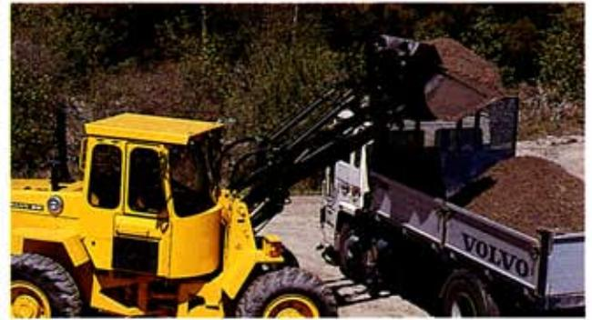
El llenado de la cuchara es siempre al 100%. Una gran fuerza de arranque (54,8 kN), y gran fuerza de elevación (45 kN) proporcionan capacidad incluso para trabajos verdaderamente difíciles. La inclinación hacia atrás con aceleración al final del movimiento de recogida, garantiza un buen llenado de la cuchara.
