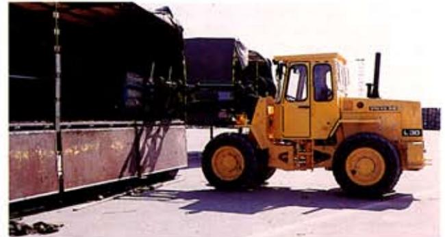
Gran altura de elevación, gran alcance y sistema de brazos totalmente en línea, permiten cargar y descargar vehículos anchos fácilmente y con rapidez, desde un solo lado, en ciclos de trabajo cortos. El desplazamiento paralelo y la excelente visibilidad garantizan un control seguro de la carga.
