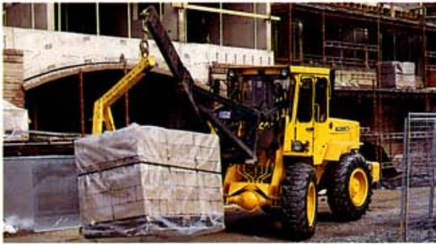
Gran alcance, gran altura de elevación, gran fuerza de arranque y gran precisión, son condiciones indispensables para un trabajo eficaz y exacto con el brazo de grúa. La Volvo BM L30 ocupa una posición completamente destacada en lo que respecta a las cargas que pueden manipularse con el brazo de grúa.
