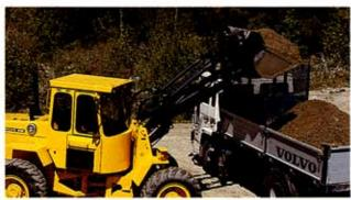
Un godet toujours plein. Une force de cavage élevée (54,8 kN) et une bonne force de levage (45 kN) également fournissent la capacité voulue, même pour les travaux lourds. L'accélération intervenant à la phase finale du basculement arrière du godet garantit un bon remplissage.
