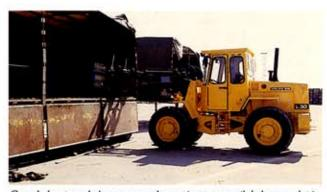
Grande hauteur de levage, grande portée et appareil de levage plat à sa partie inférieure. Il est facile de charger ou décharger des véhicules larges par un seul côté, ce qui réduit d'autant la durée des cycles. Le déplacement parallèle et une excellente visibilité permettent d'exercer un total contrôle sur la charge.
