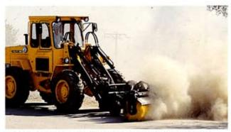
Le système hydraulique est conçu pour l'adjonction de fonctions supplémentaires. La boîte de vitesses à 6 rapports est idéale dans les situations où il est nécessaire de rouler à faible vitesse. (Equipement en option).
