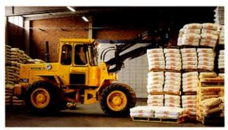
Le conducteur exerce un total contrôle sur son engin et sur la charge qu'il manutentionne, même dans les espaces restreints. Déplacement parallèle, châssis articulé et angle de braquage de 40°.
