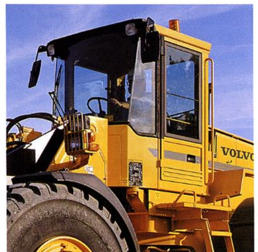
La cabine Care Cab Volvo BM est intégralement conçue pour augmenter la productivité. Le pare-brise bombé dépourvu de montants sur les côtés et les grandes surfaces vitrées contribuent à la sécurité sur le chantier. Bien entendu, la cabine Care Cab Volvo BM est homologuée ROPS/FOPS.
