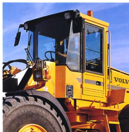
Volvo BM Care Cab är från golv till tak byggd för att höja förarens produktivitet. Den välvda framrutan utan hörnstolpar och stora glasrutor bidrar till ökad säkerhet på arbetsplatsen. Volvo BM Care Cab är givetvis ROPS/FOPS-godkänd.
