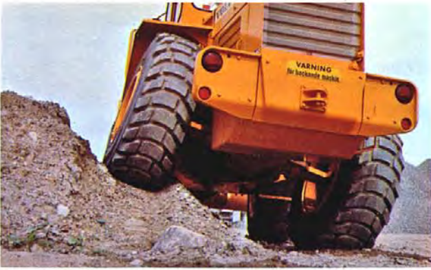
Grand débattement du pont arrière, 30° au total.
