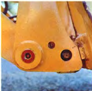
Les axes d'articulation du godet sont plus que largement calculés, pour résister aux plus durs efforts avec une grande marge de sécurité.
