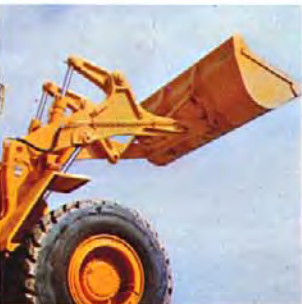
L'équipement chargeur est en acier robuste, de qualité élevée. Les bras de levage sont fixés au châssis, résistant à la torsion, par de larges points d'attache.
