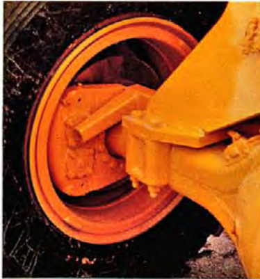
Die Bremsanlage hat zwei Kreise, um höchste Sicherheit bieten zu können. Gut geschützte Scheibenbremsen mit großen Reibungsflächen an allen Rädern.
