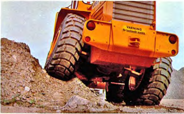
Großer Achspendelwinkel der Hinterachse – insgesamt 30°.
