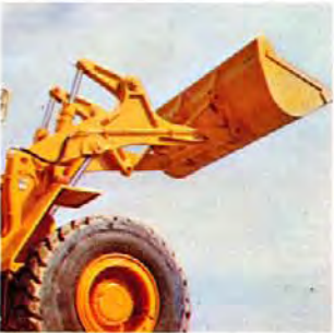
Das Ladeaggregat ist unter Verwendung hochwertiger Werkstoffe kräftig gebaut. Die Hubarme sind auf einer breiten Grundlinie an dem torsionssteifen Rahmen befestigt.
