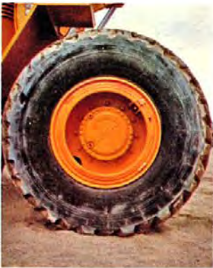
Große Räder ergeben ruhigen Lauf, gute Geländegängigkeit und Tragfähigkeit auf schlechter Fahrbahn.
