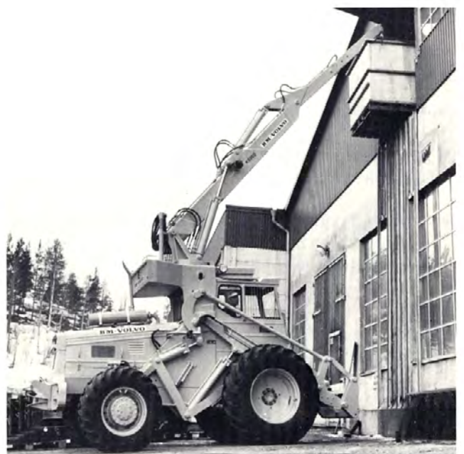
Horquilla de extensión para el fácil manipuleo de materiales.
