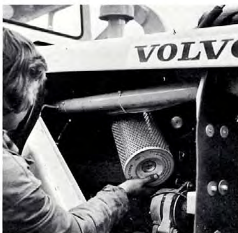
Sostituzione della cartuccia del filtro dell'aria: un'operazione semplicissima.
