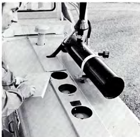
Sotto una piastra si trovano i bocchettoni per l'introduzione dell'acqua di raffreddamento, del combustibile e dell'olio idraulico. Nel tappo per l'olio idraulico è incorporato un filtro magnetico.
