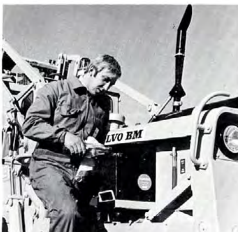
Mediante una semplice maniglia le batterie possono essere facilmente estratte per il controllo e per l'aggiunta di acqua distillata. Una finestrella di ispezione sul serbatoio dell'olio idraulico consente di verificarne il livello.
