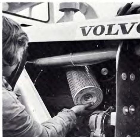
Cambio de filtro de aire – sin problemas y con amplio espacio.
