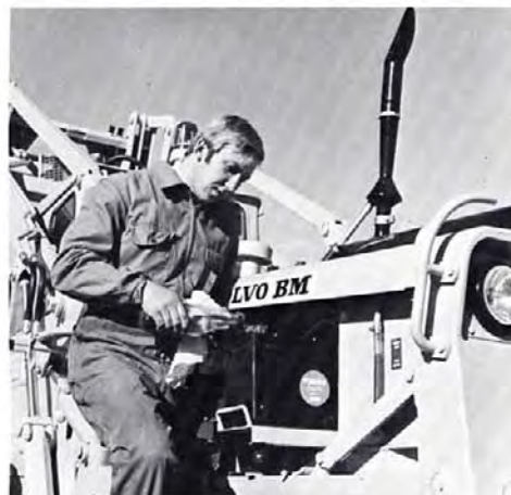
Con una sencilla maniobra se ponen al descubierto las baterías para su control y eventual llenado. El depósito de aceite está provisto con un tubo de nivel que proporciona rápida y exacta información sobre la cantidad de aceite.
