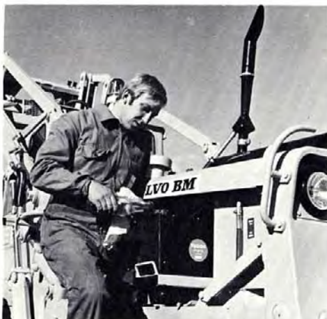
Rien de plus simple que de sortir les batteries pour les vérifier ou en compléter le niveau. Le réservoir de liquide hydraulique est muni d'un tube de niveau permettant un contrôle instantané.
