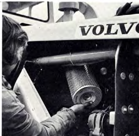
Remplacement du filtre à air. L'opération est simple et l'espace disponible est largement suffisant.
