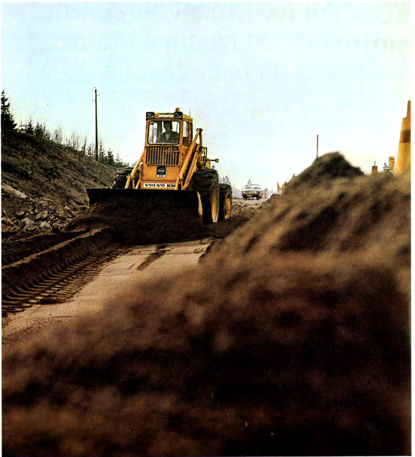
Le 641 a d'excellentes propriétés tous-terrains et une grande puissance de traction, même sur sol difficile ou meuble. Il le doit à ses quatre roues motrices de grandes dimensions et à son blocage de différentiel.
