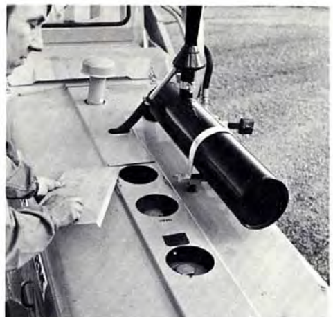
Les orifices de remplissage de l'eau de refroidissement, du carburant et du liquide hydraulique sont groupés sous un volet commun. Un filtre magnétique est incorporé au bouchon du réservoir de liquide hydraulique.
