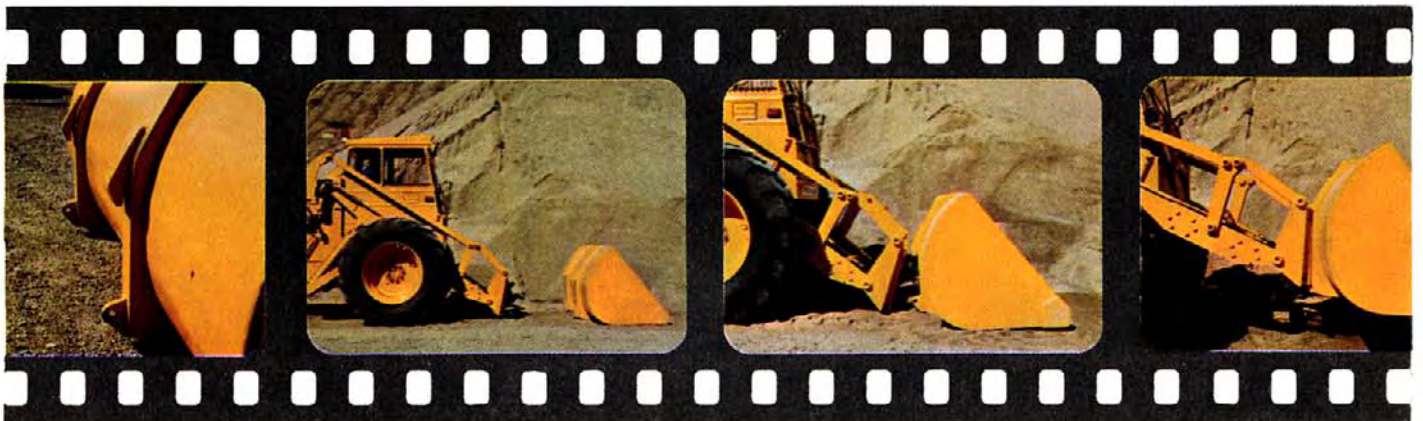
Le 641 a d'excellentes propriétés tous-terrains et une grande puissance de traction, même sur sol difficile ou meuble. Il le doit à ses quatre roues motrices de grandes dimensions et à son blocage de différentiel.
