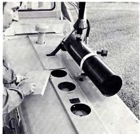
Onder een luikje zitten de vulopeningen voor koelwater, dieselolie en hydrauliekolie handig bij elkaar. In het deksel van de hydrauliekolietank zit bovendien een ingebouwd magnetisch filter.
