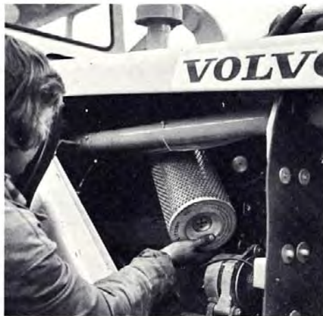
Nieuw luchtfilter inzetten – biedt geen problemen, veel bewegingsruimte.
