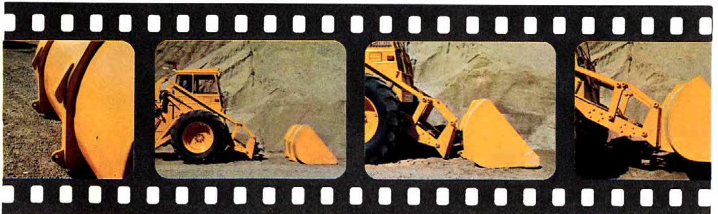
De 641 heeft een grote terreinvaardigheid en ook in het zwaarste terrein een grote trekkracht, dankzij de grote wielen, differentieelslot en 4-wielaandrijving.
