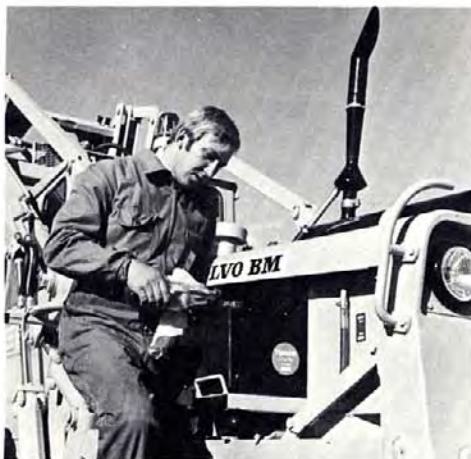
Met één enkele handgreep haalt men de accu's tevoorschijn voor controle en bijvullen. De hydrauliektank is voorzien van een peilbuis zodat snel en nauwkeurig de hoeveelheid hydrauliekolie afgelezen kan worden.
