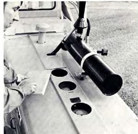
Unter einer Platte sind die Deckel für das Einfüllen des Kühlwassers, Kraftstoffes und des Hydraulöls. Im Deckel des Hydraulölbehälters ist ein Magnetfilter eingebaut.
