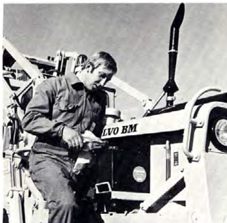
Durch einen einfachen Griff, können die Batterien leicht zur Kontrolle und zum Auffüllen von destilliertem Wasser herausgezogen werden. Ein Schauglas am Hydraulölbehälter zeigt den Pegelstand an.
