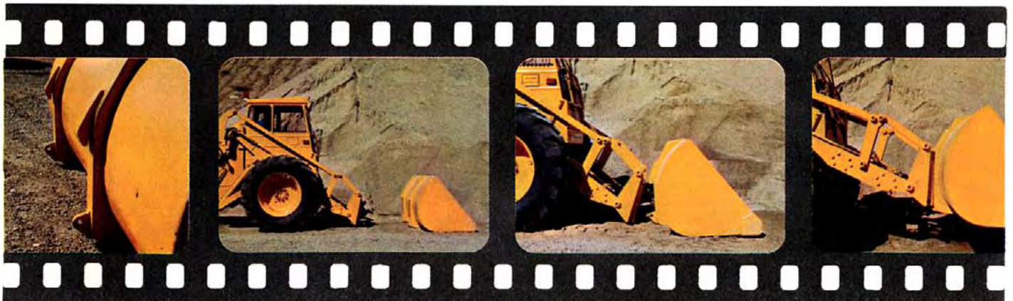
Der VOLVO BM 641 hat durch die übergroßen Reifen, der Differentialsperre und dem Vierradantrieb eine ausgezeichnete Geländegängigkeit und Schubkraft auch in schwerem Gelände.
