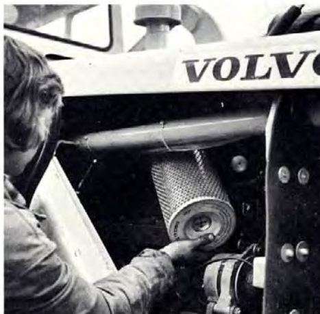
Austausch der Luftfilterpatrone – einfach und problemlos.
