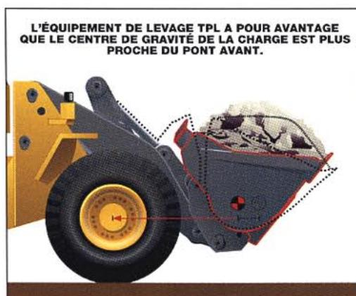
La cinématique des bras de levage autorise une configuration de godet grâce à laquelle la charge manutentionnée est la plus proche possible du pont avant. Cela augmente la stabilité et permet d'utiliser au maximum la charge de basculement disponible. Le pointillé correspond à un système d'articulation en Z conventionnel.
