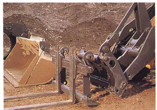
*Le porte-outil à verrouillage hydraulique vous permet de fixer en quelques secondes n'importe lequel des outils et accessoires d'origine Volvo BM.*
