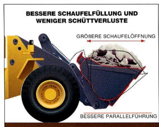
*In Transportstellung wird die Schaufel so weit zurückgekippt, daß die Öffnung im Prinzip parallel zum Boden steht. Das verringert die Gefahr von Materialverlusten beim Transport. Da die Schaufelöffnung aufgrund der Bauweise des Hubgerüsts besonders groß dimensioniert werden kann, erzielt man auch eine bessere Schaufelfüllung. Die gestrichelte Linie zeigt die Schaufelposition bei herkömmlicher Z-Kinematik.*
