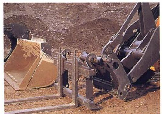
*Mit den hydraulischen Schnellwechslern lassen sich Volvo BM-Anbaugeräte im Handumdrehen austauschen.*
