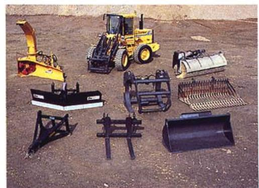
*Für die Volvo BM-Radlader gibt es außerdem noch viele Spezialgeräte, die in Zusammenarbeit mit wenigen, ausgewählten Lieferanten hergestellt werden. Die Abbildung zeigt als Beispiele eine Schneeschleuder, eine Kehrwalze, einen verstellbaren Schneepflug und eine Gitterschaufel zusammen mit einer Auswahl an Originalgeräten.*
