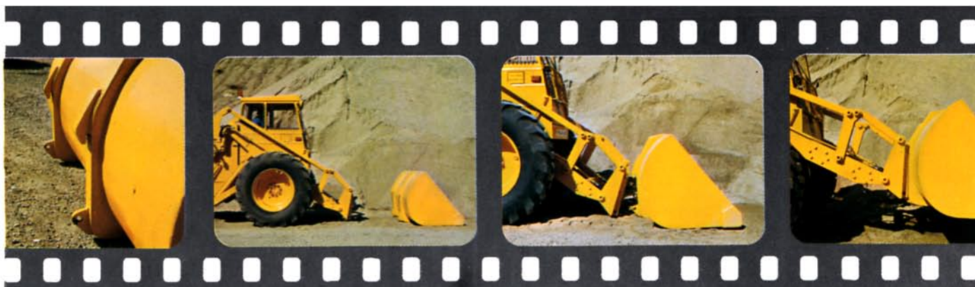
641 har god framkomlighet och dragkraft även i svår terräng och på dåliga markförhållanden tack vare stora hjul, diffspärr och 4-hjulsdrift.
