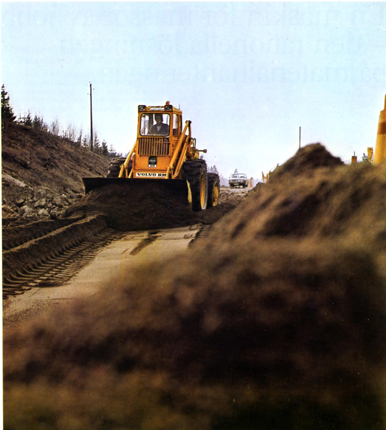
641 har god framkomlighet och dragkraft även i svår terräng och på dåliga markförhållanden tack vare stora hjul, diffspärr och 4-hjulsdrift.
