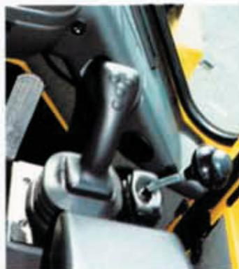
Schluß mit dem umständlichen Hantieren bei der Arbeit! Der neue Multifunktionshebel für die Servovorststeuerung macht's möglich. Per Knopfdruck regeln Sie Fahrtrichtung, Neutralstellung und Differentialsperre - ohne die Hand vom Griff zu nehmen. Und sollte Ihnen die gewohnte Schaltung lieber sein: Kein Problem, der herkömmliche Schalthebel ist ebenfalls serienmäßig installiert.
