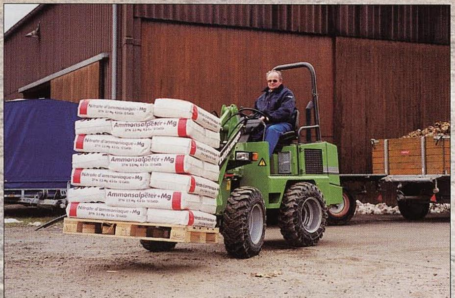
Harte Arbeit leicht gemacht: Mit einem agroliner-Hoflader erledigen Sie Verladung und Transport von schweren Lasten in einem zügigen Arbeitsgang.
