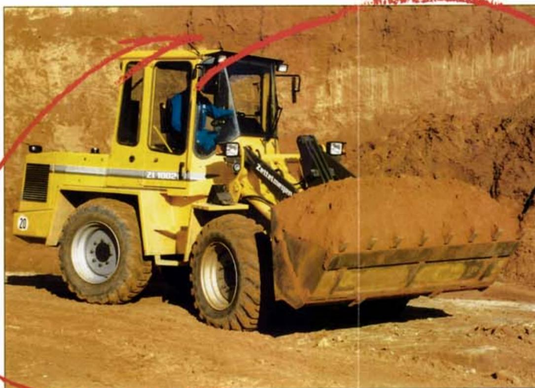
TP-Kinematik die kombinierte Kinematik mit den bewährten Vorteilen: Parallelität im Hubvorgang und kontrolliertes Auskippen in den oberen Hubpositionen.
