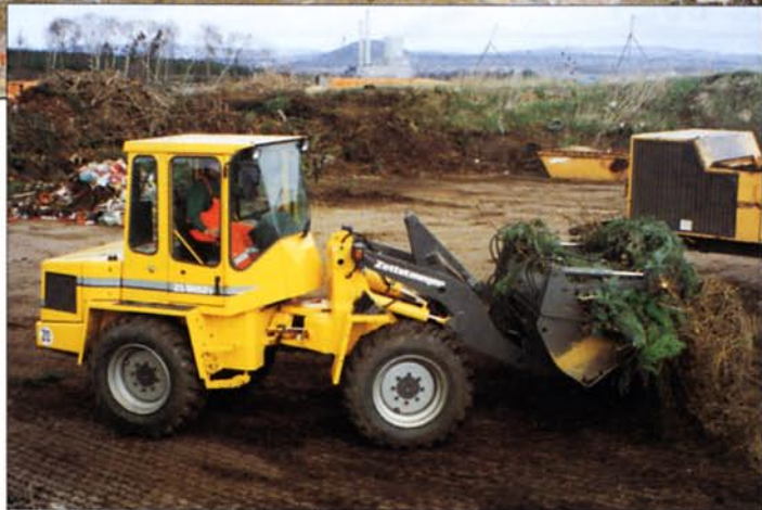
Godet à végétaux à abatant hydraulique, alimentation de broyeur.
