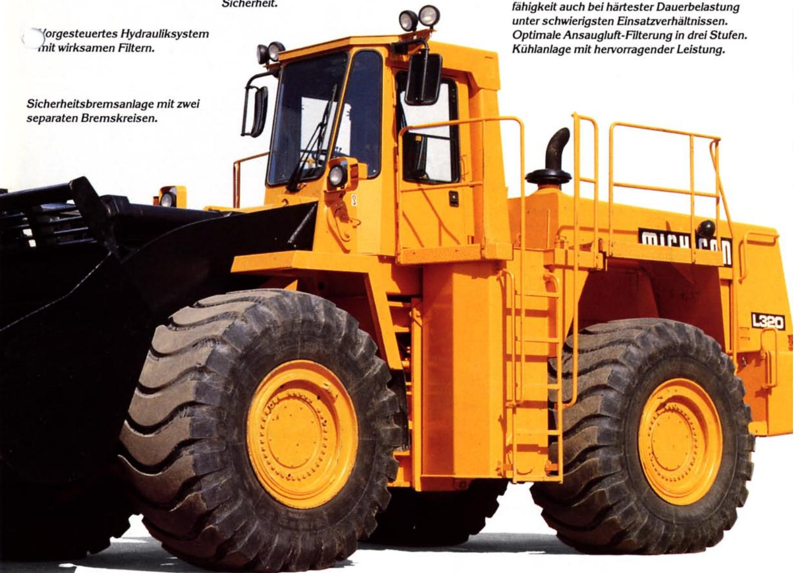
*Großartig bemessene Nabenvorgelege verringern die Belastung der Antriebswellen. Verschleißfeste Rollenlager.*
