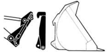
Zusatzgeräteträger für alle BM-VOLVO-Standardgeräte
