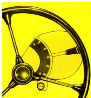
Nopea ja vaivaton vaihtaminen ilman kytkinpoljinta — vaihteenvalitsin mukavasti ulottuvilla ohjauspyörän alla.
