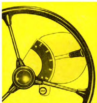
Hurtig frem- og tilbagekørsel — uden brug af koblingspedal, kun med et greb i gearvælgeren under rattet.
