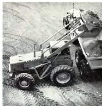
Hurtig frem- og tilbagekørsel — uden brug af koblingspedal, kun med et greb i gearvælgeren under rattet.
