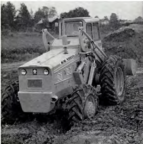
El reducido radio de giro acorta el tiempo de cada ciclo de trabajo, lo cual se traduce en gran capacidad.
