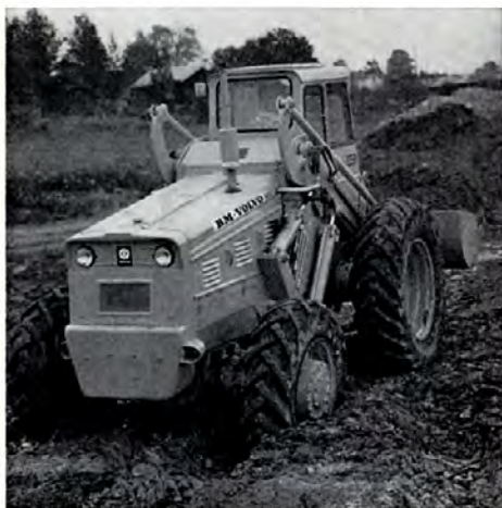
Le faible rayon de braquage du LM 640 permet de raccourcir le trajet entre chaque opération — d'où rendement élevé.
