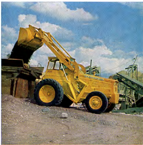
Le faible rayon de braquage du LM 620 permet de réduire les trajets entre opérations, ce qui augmente les rendements.
