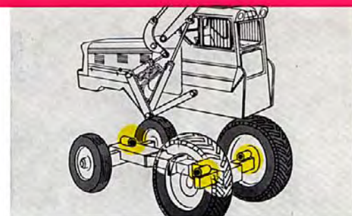
Dreipunktaufhängung des Ladeaggregates verhindert nachteilige Auswirkung der Beanspruchungen auf das Chassis.
