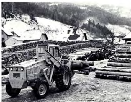
LM 422 assurant la manutention de rondins de pâte à papier en Autriche.
