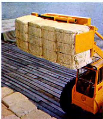
Pince à serrage hydraulique pour la manutention des balles de pâte à papier.
