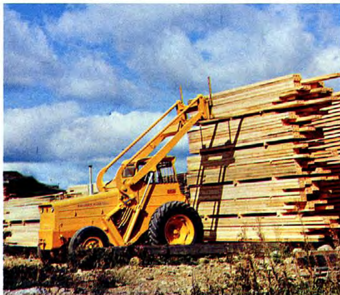
La grande hauteur de levage est un avantage considérable dans les parcs à bois.
