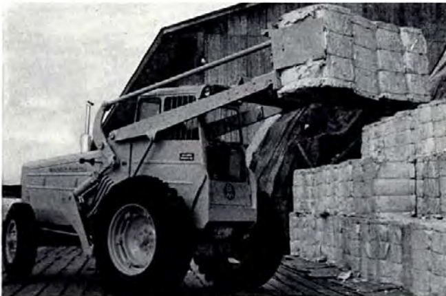
Manutention de marchandises en balles à l'aide de la pince à serrage hydraulique.
