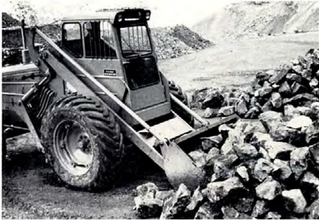
Chargement de pierres, de débris de rocher et de pierres à chaux à l'aide du godet pour débris de rocher ou du godet à claire-voie.
