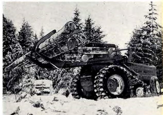
Halage et chargement de grumes et de bois à pâte. La machine est équipée de semi-chenilles et de tôles de protection ainsi que d'une pince à grumes ou à bois à pâte.
