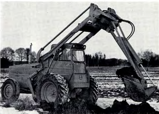
Excavation de tranchées à câbles et de petits fossés. Bras excavateur à commande hydraulique pouvant pivoter de 180°.
