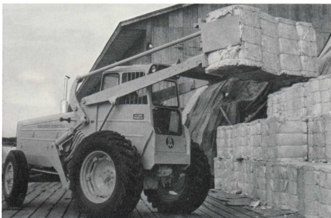
Hantering av balat gods med hydrauliskt manövrerad kläm-gaffel.
