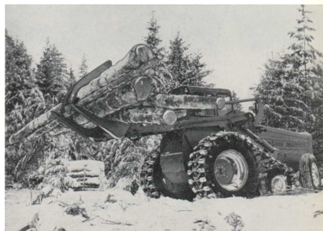
Lunning och lastning av timmer och massaved. Maskinen försedd med halvband och skyddsutrustning samt timmer- eller massavedsgaffel.
