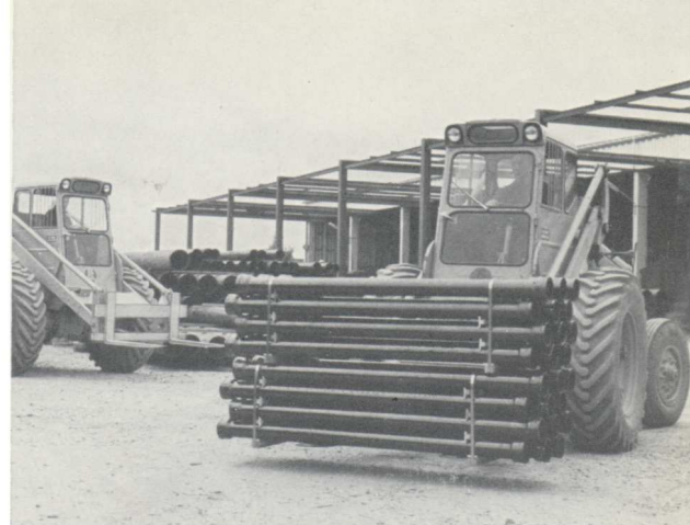
Hantering av buntat och pallat gods, sågat virke samt trä- och plåtfat med vinkel- och fatgafflar.
