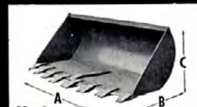
Nr. 3 Zand- en grintschop met spitse voorkant en tanden
