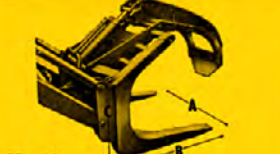
Nr. 10 Hefvork met hydraulische knijparm (rondhoutknijper)
