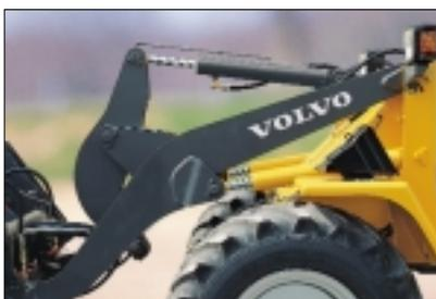
Cinemática en Z - el sistema de elevación robusto y polivalente tiene fuerzas de elevación y de arranque excepcionales.
