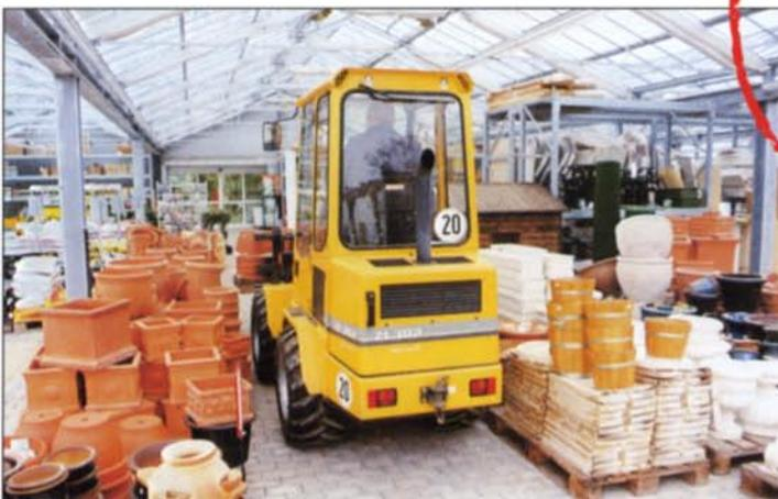
Parallelkinematik für gute Staplereigenschaften - Flüssiges Be- und Entladen in jeder Hubhöhe durch Parallelführung der Arbeitsgeräte.
