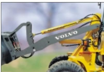
Parallelkinematik für gute Staplereigenschaften - Flüssiges Be- und Entladen in jeder Hubhöhe durch Parallelführung der Arbeitsgeräte.
