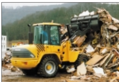
Bras de levage TP - le système combiné qui a fait ses preuves : parallélisme lors du levage et déversement contrôlé même dans les positions les plus élevées.
