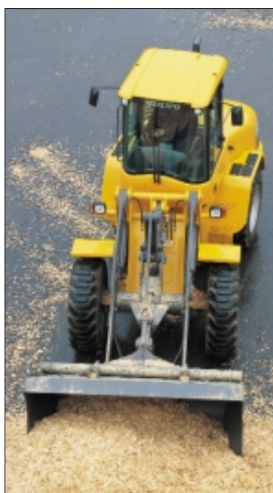
Bras de levage TP - le système combiné qui a fait ses preuves : parallélisme lors du levage et déversement contrôlé même dans les positions les plus élevées.
