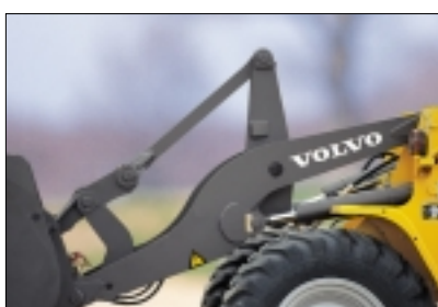
Bras de levage TP - le système combiné qui a fait ses preuves : parallélisme lors du levage et déversement contrôlé même dans les positions les plus élevées.
