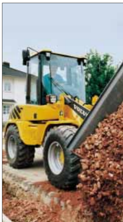
TP-Kinematik mit starken Rückhaltekräften auch im oberen Hubbereich.
