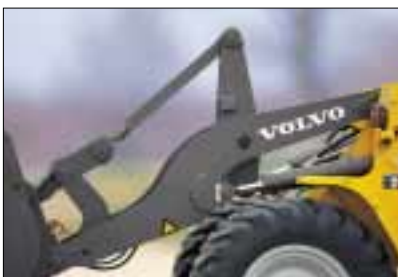
TP-Kinematik mit starken Rückhaltekräften auch im oberen Hubbereich.
