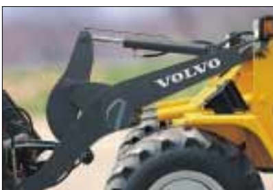
Z-Kinematik mit hohen Reiß- und Hubkräften.
