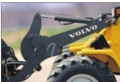
Z-Kinematik - die robuste Vielzweck-Kinematik mit den hohen Reiß- und Hubkräften. Kraftvoll in Verladung und Produktion.
