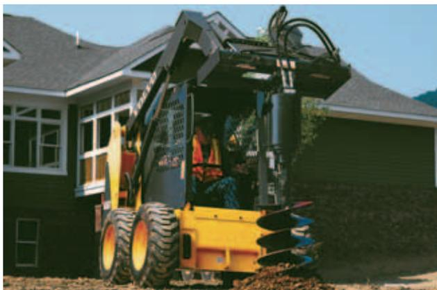
X1975 – Servicios Medios/pesados, accionamiento planetario, una velocidad.
