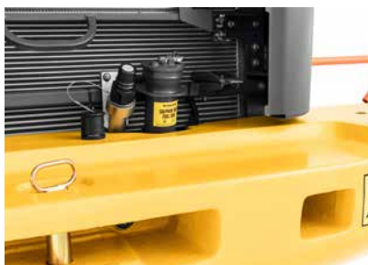
Système de remplissage rapide de carburant
