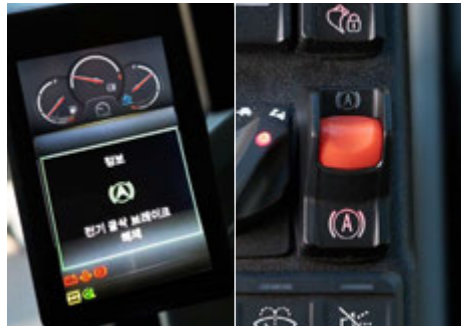
자동 제동 기능(ADB) 옵션 •장비가 멈추면(주행속도 0Km/h) 자동으로 브레이크가 걸리고, 액슬이 록킹되는 기능
